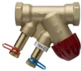
Afin de garantir la performance énergétique et le confort par la bonne répartition des débits à pleine charge tout en limitant le nombre de vannes installées, les vannes 2 voies seront de type combinées, équilibrage et régulation, à caractéristique linéaire. Produits de référence TBV-C de IMI TA.
